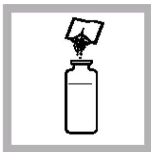
5. 加入一包过硫酸钾粉包到装有25mL样品的比色瓶中，混合。
