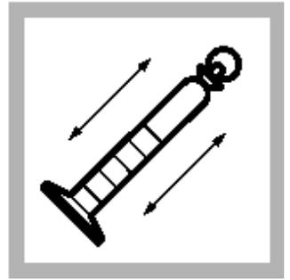
4. 盖上盖子，然后摇晃量筒使试剂溶解。此为待测试样。
