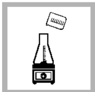
1. 把一升样品放入 2000ml 长颈瓶, 加入磁搅拌器, 放置在磁动加热器上。
