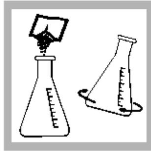
2、将 Potassium Persulfate 药包加入试样，充分摇晃混合。
