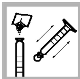
3. 加入一包钾1试剂粉包。加入一包钾2试剂粉包。盖上盖子, 倒转几次混合。
