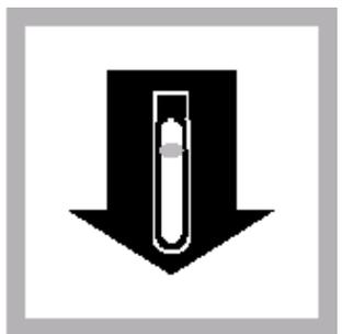
17.将样品瓶装配入适配器。按READ，结果将显示C的含量，单位为mg/L。
