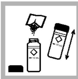
3. 在样品池中加入一份 NitriVer3 亚硝酸试剂，盖紧摇晃至完全溶解，如有亚硝酸盐存在，则溶液应该显品红色
