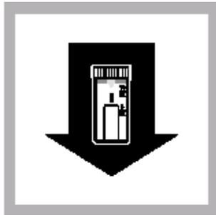
6. 擦干净管外壁，放入适配器中。按 READ，即可测得 mg/L余氯。
