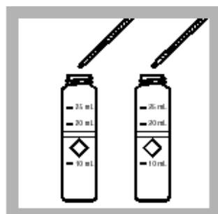
5. 分别量取5.0 mL 碳酸钠溶液到两个管中, 混合。
