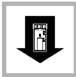
7. 擦干净管外壁，放入适配器中。按 READ，即可测得 mg/L总氯。
