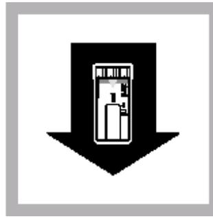
3. 装上样品适配器，将比色瓶置入机内，面对短光程，盖上遮光盖。
