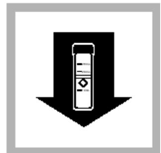
8. 将待测样品放入比色管槽, 按READ, 屏幕将显示亚铁的含量, 单位为mg/L。
