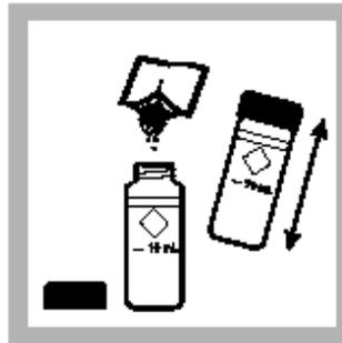
3. 加入一包TPTZ铁试剂粉包到比色管中(待测样品), 混合摇晃30秒, 打开盖。
