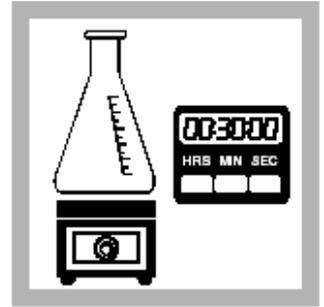
4、将锥形瓶放在加热板，缓缓加热 30 分钟。避免蒸干。
