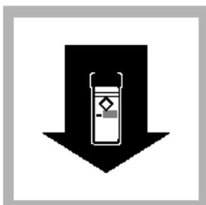
6. 将空白试样放入样品管槽。
