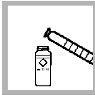
3. 用量筒量取 10 mL 样品到另一个比色管中(待测样品)。
