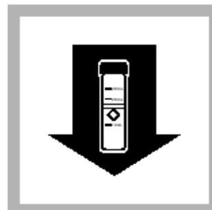
8. 将待测样品放入比色管槽, 按READ, 屏幕将显示铁的含量, 单位为mg/L。
