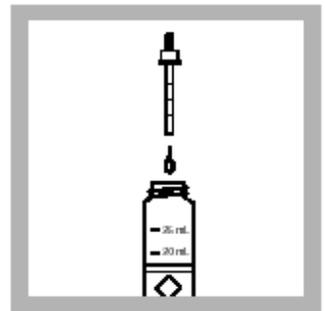
8. 加入一滴 1 M 的 EDTA 溶液到比色管中 (空白试样), 混合。
