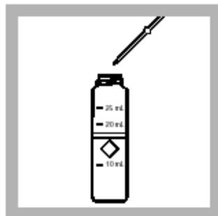
4. 取出0.5mL过滤液或上清液到另一个25mL的干燥比色瓶中(待测试样)。
