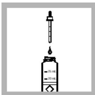
9. 加入一滴 1 M 的 EDTA 溶液到比色管中 (待测样品), 混合。
