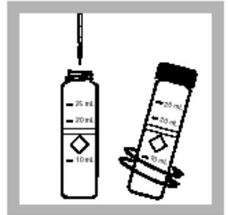
12. 用 1-mL塑料点滴器，加入 1.0 mL pPb-4 中和溶液到样品管中，充分混合，立即进行步骤 13。
