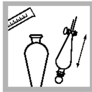
7. 当计时器鸣叫时, 加入10 mL 氯仿, 盖上盖子, 轻轻摇晃, 倒转。使尖部超上并不能对着旁人, 打开活塞通气。
