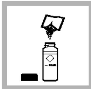
3. 加入一包 NitriVer 2亚硝酸盐试剂粉包, 盖上盖子, 摇晃使溶解(待测试样)。
