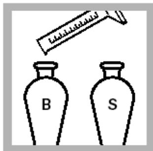
11. 分别加入30 mL甲苯到两个漏斗中，盖好盖子，混合，然后打开活塞通气，再关上活塞。重复两次。
