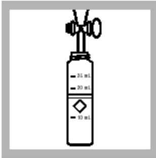
10. 当计时器鸣叫时, 等待溶液分层。在漏斗的出液管中塞入豌豆大小的棉花, 分出氯仿层 (下层) 到一个比色管中 (待测样品), 盖好盖子。
