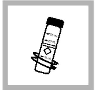
12. 旋转比色管混合萃取物。萃取液的最终体积应大约25mL, 是由于氯仿在水中微溶。
