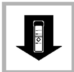
8. 将待测试样放入比色瓶槽, 按READ, 屏幕将显示季铵盐或十六甲基-三甲基铵溴化物的含量, 单位为mg/L。
