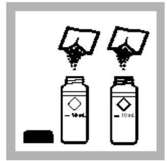
4. 加入一包 Porphyrin 1试剂粉包到每个比色管中。混合使溶解。
