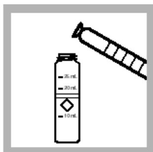
6. 从量筒中将溶液倒入一个25mL的比色管中(待测样品)。
