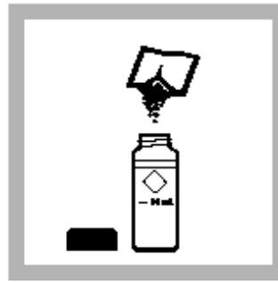
3. 加入一包 Copper Masking试剂粉包到其中一个比色瓶中 (空白试样)。混合使溶解。
