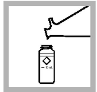
8. 往另一个样品管中装入10mL过滤过的样品(预制试样)。
