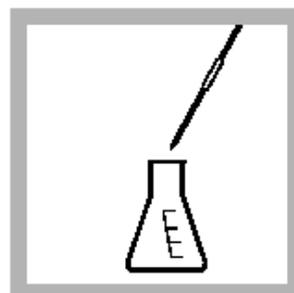
4. 准确量取2.0 mL去离子水到125mL的塑料锥形瓶中(空白试样)。
