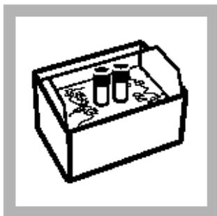
7. 将两个比色瓶放入沸水浴中。注: 可以在500mL的大口杯中加热比色瓶。
