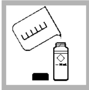
2. 往一个带玻璃塞子的比色管中装入样品至10mL刻度。(待测样品)。
