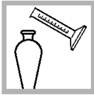
2. 用500ml的量筒量取300mL样品, 倒入500mL分液漏斗中。
