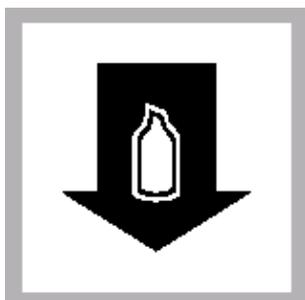
9. 将试剂空白的真空安培瓶放入比色瓶槽, 屏幕将显示臭氧的含量, 单位为 mg/L。
