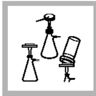
3. 装配过滤装置(0.45微米的膜过滤器, 过滤架, 过滤瓶和吸气瓶)。NCASI指定用0.8微米过滤器。
