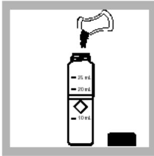
6. 加入一包 FerroMo 铁试剂 2 粉包到比色管, 摇晃使试剂溶解。此为进一步的样品。
