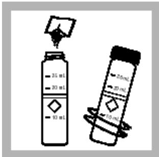
13. 加入一包 pPb-5 指示剂粉包到样品管中，充分混合。注：溶液颜色将变棕色。
