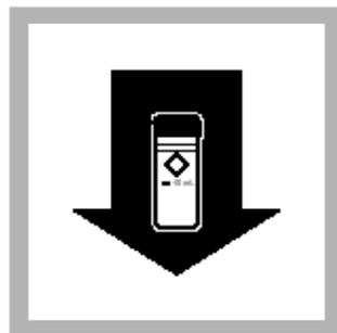
12. 将待测试样放入比色瓶槽。按READ，屏幕将显示锌的含量，单位是mg/L。
