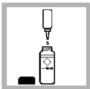
5. 分别加入 15滴碱性氰化物试剂溶液到每个样品管中, 混合。
