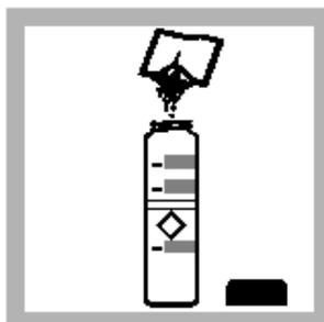
3. 加入一包 BariVer 4 Barium试剂粉包到样品管 (待测试样)。旋转混合。
