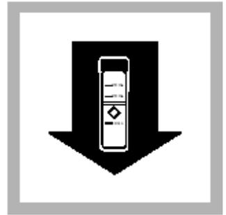
16. 将第三个比色管放入比色管槽。屏幕将显示钙(以碳酸钙的形式)的含量, 单位为mg/L。钙结果为样品中以CaCO<sub>3</sub>形式表达的钙的含量。
