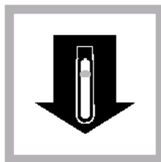
7. 用毛巾擦瓶外壁，将待测样品放入比色瓶槽。
