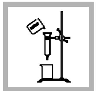
8. 将预制试样缓慢滴加入快速柱式萃取器中, 等样品流过萃取器。
