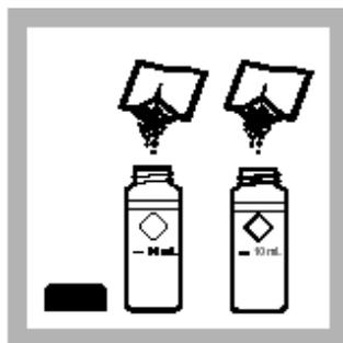
5. 加入一包 Porphyrin 2 试剂粉包到每个比色管中。混合使溶解。
