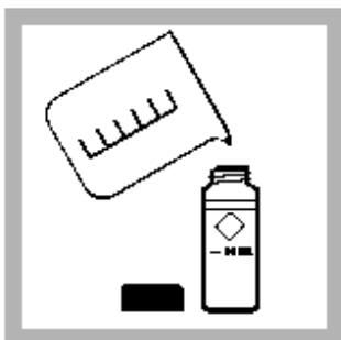
2. 往带玻璃塞的样品管中装入样品至10mL刻度线(预制试样)。
