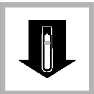
15.把待试样品放入适配器内。按READ，结果将显示C的含量，单位为mg/L。
