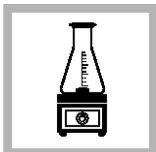
7. 搅拌并 90 度加热两小时。注: 溶液应保持深紫色, 否则应加高锰酸钾。
