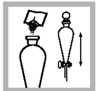
8. 分别加入一包苯酚2试剂粉包到每个分液漏斗中, 盖好盖子, 摇晃使粉末溶解。
