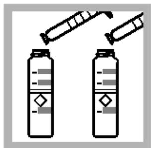
9. 从每个量筒中各倒出 25 mL 溶液到相应的比色瓶中。
