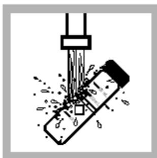
6. 当计时器鸣叫时, 取出预制试样。用流动的水冷却管至25°C。
