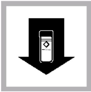
9. 待测样品放入比色管槽。按READ，屏幕将显示铜的含量，单位为 $\mu\text{g/L}$ 。
