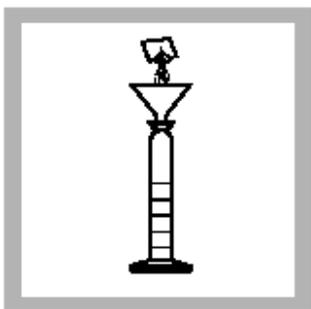
33. 将所收集的溶液加入 HgEX 3 铝箔包试剂, 并摇匀。
