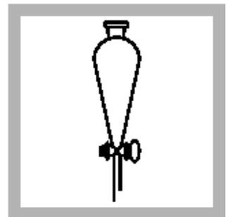
8. 当计时器鸣叫时，取走塞子并分出下层水层，弃去该水层，放入适当的废物收集器中。
