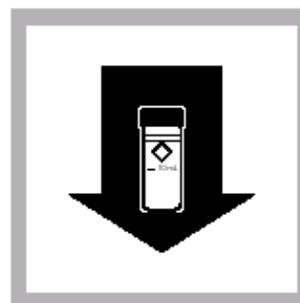
6. 将预制试样放入样品管槽。关上遮光盖。按READ, 屏幕将显示ClO<sub>2</sub>的含量, 单位是mg/L。
