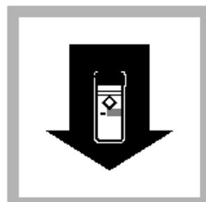
8. 计时器鸣叫后3分钟内, 将预制试样放入样品管槽。按READ。屏幕将显示溴的含量, 单位是mg/L。
