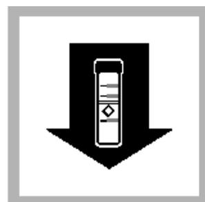
12. 将预制试样放入样品管槽，关上遮光盖，按READ。屏幕将显示苯并三唑或甲苯并三唑的含量，单位是mg/L。
