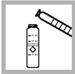
5. 往一个干净的配套的比色管装入待测样品至25mL刻度线。保留余下的25mL待测样品用于步骤8。
