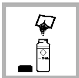
6. 加入一包 DPD 自由氯试剂粉包到预制试样的样品管中。旋转比色瓶管 20 秒混合。
