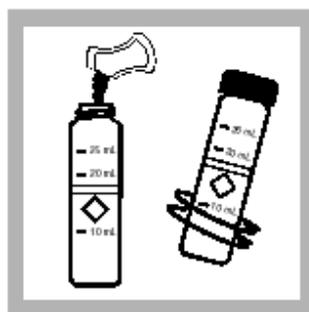
6. 加入一包硫代硫酸钠粉包到空白样品中, 混合30秒使粉末溶解。
