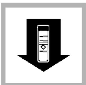
6. 当计时器鸣叫时, 将空白试样放入样品管槽。关上遮光盖。
