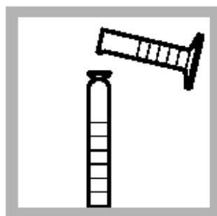
4. 用 50-mL量筒加入 50 mL 样品到步骤3中的 50-mL混合量筒中, 盖好盖子。倒转混合一分钟。
