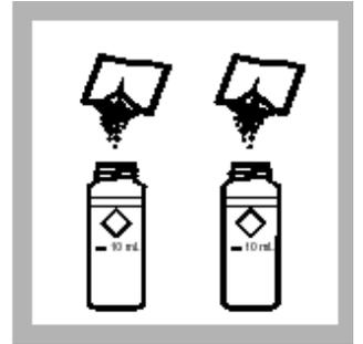
4. 往每个管中分别加入一包 Phthalate-Phosphate 试剂粉包, 盖好盖子, 立即摇晃使粉末溶解。
