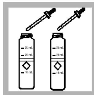
4. 分别加入 1.0 mL 硫化物1试剂到每 个管中, 混合。
