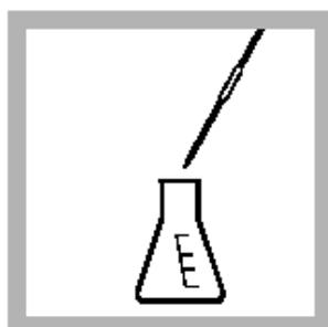
5. 准确量取2.0 mL 样品到另一个125mL的塑料锥形瓶中(待测试样)。
