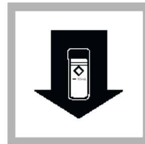
9. 当定时器显示 **12: 00**, 在空白样量筒中加入 2.5ml 低量程甲醛显影液, 塞上塞子, 倒置混合
