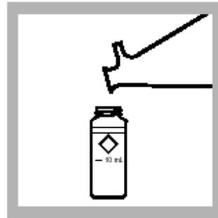
6. 往样品管(空白试样)中装入10mL过滤过的去离子水, 弃去多余的液体。
