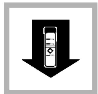
12. 将待测样品放入比色管槽, 按 READ, 屏幕将显示镁 (以碳酸钙的形式) 的含量, 单位为 mg/L。该显示值即为样品中以 CaCO<sub>3</sub> 形式表示的镁含量。
