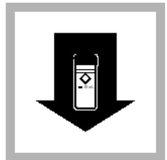
8. 将待测样品放入比色管槽, 计时器鸣叫后, 立即按 READ, 读出屏幕上显示的联氨的含量, 单位  $\mu\text{g/L}$ 。
