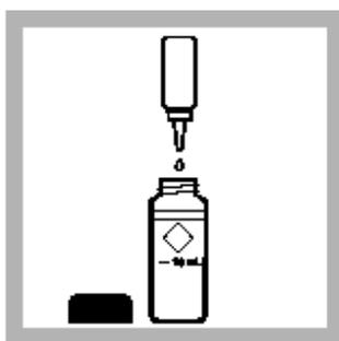
6. 分别加入21滴PAN 指示剂溶液, 0.1%,到每个样品管中, 混合。
