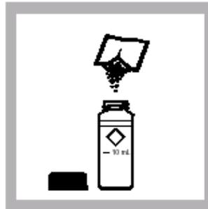
6. 将 DPD 自由余氯试剂药包加入一个试样，盖上瓶口摇晃均匀。摇晃 20 秒，立刻进行第七步。
