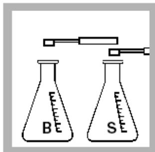
3. 分别加入一勺0.2-g量的TitraVer Hardness试剂到每个锥形瓶中, 混合。
