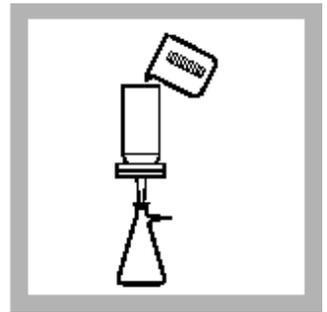
4. 用大约50mL的去离子水冲洗过滤器, 弃去冲洗液。
