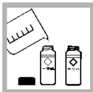
2、将两个样品瓶注入 10ml 的样品。
