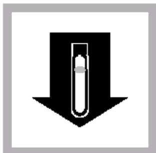
13. 安装16-mm适配器。用湿毛巾擦试剂空白样，将试剂空白瓶装配入适配器。
