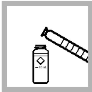
5. 将10 mL待测试样倒入一个配套的比色瓶中。
