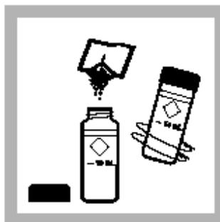
3. 加入一包FerroVer铁试剂粉包到比色管中(待测样品), 混合。
