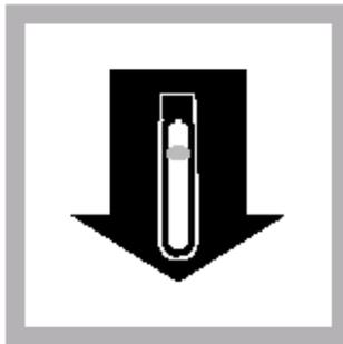
19. 以待测管置换空白管。屏幕即显示水样总氮含量。
