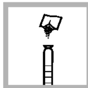
4. 加入一包 Dechlorinating 试剂粉包到其中一个量筒中, 盖上盖子, 倒转多次直到溶解, 此为空白试样, 其余的溶液为样品测定准备。
