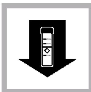
9. 将空白试样放入样品管槽。盖上遮光盖。
