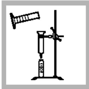
10. 将 25-mL的样品管放在萃取器下，用 25-mL塑料量筒加入 25mL pPb-3 Eluant 洗提液到萃取器中。
