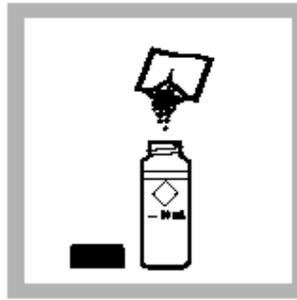
3. 将 DPD 总氯试剂药包加入一个试样，盖上瓶口摇晃均匀。摇晃 20 秒均匀。
