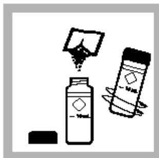
3. 加入一包 SulfaVer 4 试剂粉包到比色瓶中, (待测样品), 混合。
