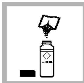
3. Total Chlorine 粉包到样品管 (预制试样)。旋转混合。如有溴存在, 将呈粉红色。
