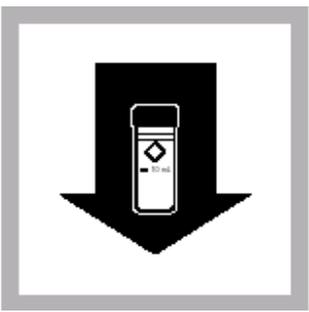
11. 将待测样品放入比色瓶槽，按READ，屏幕将显示钼的含量，单位为mg / L。
