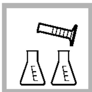
6. 用50mL量筒加入35 mL BoroVer 3/硫酸试剂溶液到每个锥形瓶中。充分混合。
