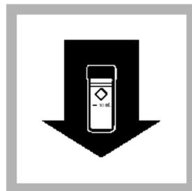
6. 擦干样品池外壁，将其置入适配器
