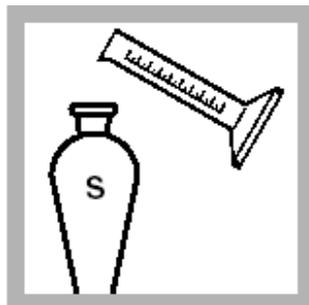
5. 将量取好的样品倒入另一个500mL分液漏斗中(待测试样)。
