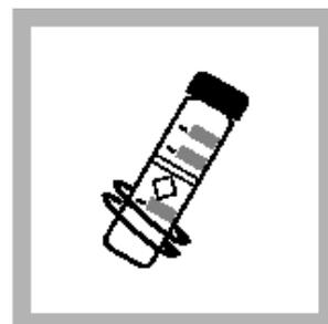
8. 当计时器鸣叫时，关紫外灯。从样品管中取出紫外灯。旋转样品管使充分混合。
