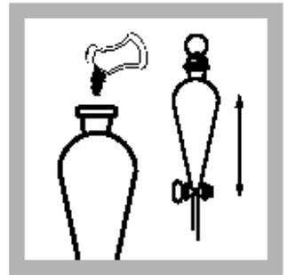
4. 加入一包洗涤剂试剂粉包到漏斗中，盖好漏斗，并摇晃使粉末溶解。
