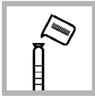
2. 将 100 mL样品倒入 100mL 的混合量筒中。
