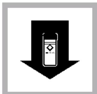
8. 将待测样品放入比色瓶槽, 按READ, 屏幕显示 $\text{PO}_4^{3-}$ 的含量, 单位为mg/L。
