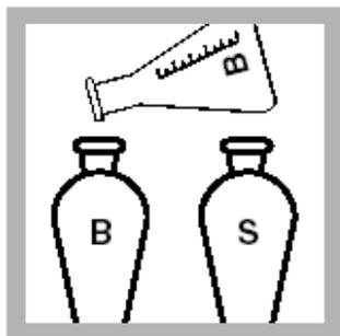
9. 将两个瓶里的内容物分别转移到两个250mL的分液漏斗中，标记其中一个为“空白试样”，另一个为“样品”。
