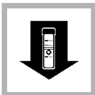
16. 将待测样品放入比色瓶槽。按READ，屏幕将显示苯酚的含量，单位为mg/L。
