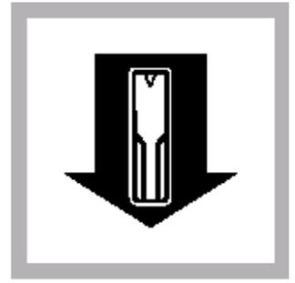
8. 将第 1 个"calibrator"放入仪器内. 按"Read"键, 仪器将会显示出吸光度值. 记录下每个"calibrator"和样本的吸光度值。
