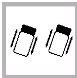
5. 将盖盖严实, 倒转多次, 溶液变热。冷却到室温再继续测试。
