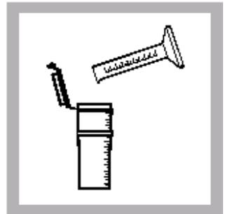
4. 用圆筒量杯往提炼瓶中加入10mL提取剂;
