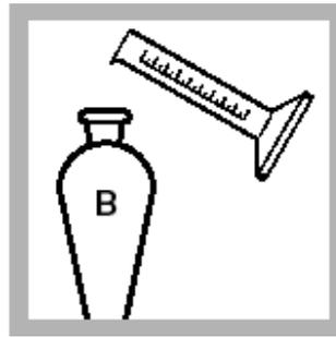
3. 将量取好的去离子水倒入一个500mL分液漏斗中(空白试样)。
