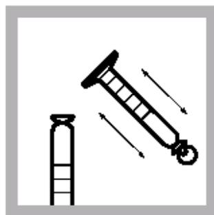
4. 加入1 mL氨基酸试剂溶液，盖上盖子，混合（待测样品）。
