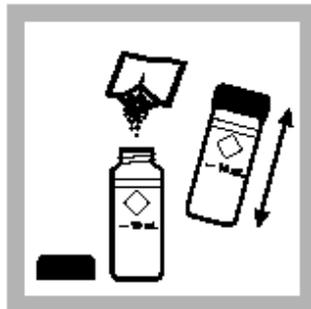
5.加入一包TPTZ铁试剂粉包到比色管中(空白样品), 混合摇晃
