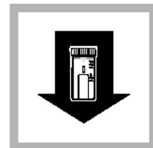
7. 把样品管放入机内, 结果显示 Cl<sub>2</sub> mg/L。
