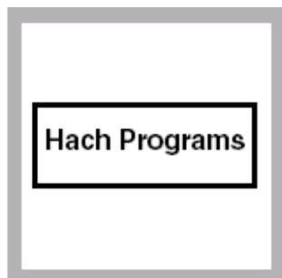
2. 在HACH PROGRAM下,选择acid hydrolyzable phosphorus程序编号536,按START。
