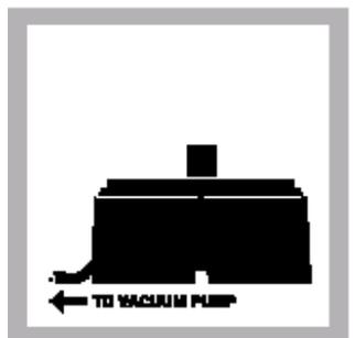
1. VPD应与真空泵相连(不是吸气型的真空泵), 并能产生20-25英寸汞柱的真空度。
