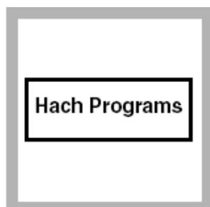
1. 在 HACH PROGRAM 下, 选择二氧化氯的程序编号76, 按START。注: 样品必须立即分析; 为得到最佳结果, 对每种试剂均测定试剂空白。
