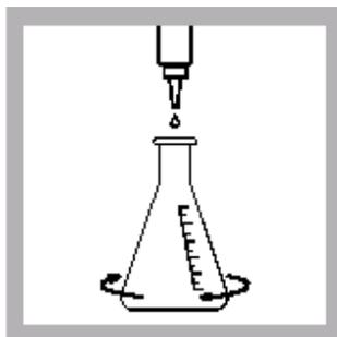
10. 从仪器中取出比色管。加入一滴极低范围硬度用的CDTA试剂。注: 在1-2分钟内完成步骤10-11。盖上管盖, 混合。
