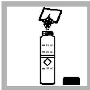
3. 加入一包铬1号试剂粉包(预制试样)混合。
