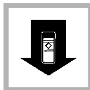
8. 将预制试样放入样品管槽, 关上遮光盖。加入试剂1分钟内读数, 屏幕将显示二氧化氯的含量, 单位为mg/L。
