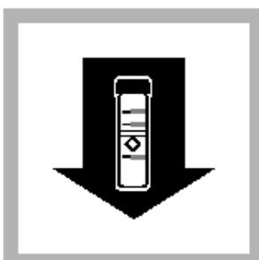
8. 计时器鸣叫后10分钟内, 将预制试样放入样品管槽, 盖上遮光盖, 按READ。屏幕将显示钡的含量, 单位是mg/L。
