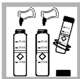
3. 分别加入一包Q. A. C. 试剂1粉包到每个管中, 旋转(不要摇晃)比色瓶使试剂溶解。
