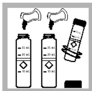
4. 分别加入一包Q. A. C. 试剂2粉包到每个管中, 旋转(不要摇晃)比色瓶使试剂溶解。
