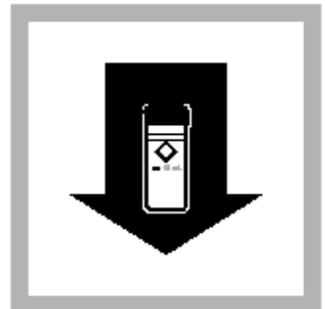
8. 将待测样品放入比色管槽, 按READ, 屏幕将显示铁的含量, 单位为mg/L。
