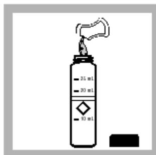
3. 加入一包 FerroZine 铁试剂粉包到比色管中(待测样品), 混合。
