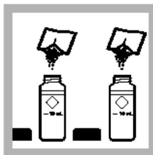
7. 当计时器鸣叫时, 加入一包EDTA试剂粉包到每个管中, 盖上盖子。摇晃使溶解。
