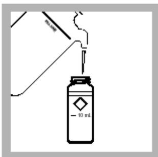
3. 往另一个带玻璃塞的样品管中装入去离子水至10mL刻度线(空白试样)。
